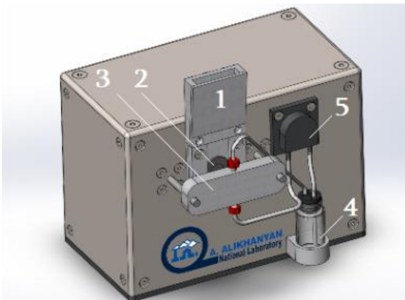
Նկար 2. Լուծման/օքսիդացման կայան: (1) ընդունիչ, (2) թիրախի վերջնական դիրք, (3) լուծման/օքսիդացման խցիկ, (4) ջրածնի պերօքսիդի փարա, միաժամանակ լուծված թիրախի փարա, (5) պերիստրալիկ պոմպ:
